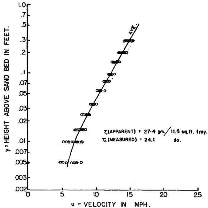
FIG. 4. AVERAGE DISTRIBUTION OF WIND VELOCITY WITH HEIGHT ABOVE A 0.15-0.25 MM DRIFTING SAND SURFACE, SHOWING THE RANGE OF VALUES OBTAINED FOR REPEATED TESTS AT ONE PRESSURE LEVEL OF THE FAN.
